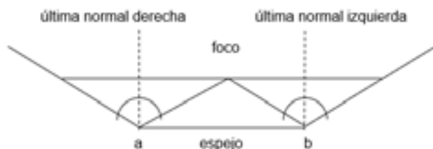
Figura 2.7.- El foco se acerca a la superficie del mismo espejo anterior. Se abre el ángulo del rayo reflejado, y por consiguiente el del rayo incidente.
