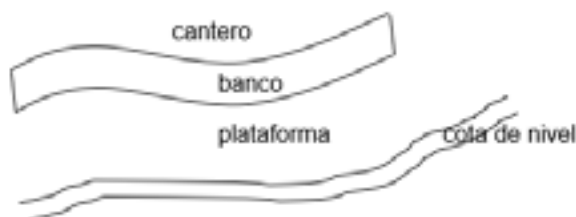
Figura 1.14.- Banco elaborado in situ, siguiendo la curva de la cota de nivel.
