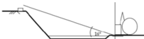
Figura 1.9.- Espejo panorámico con ángulo de 16^\circ conformado por la arista del nivel del agua con la fachada del elemento más cercano, hasta el punto visual del mirador, (estos puntos se calculan en el siguiente capítulo).
