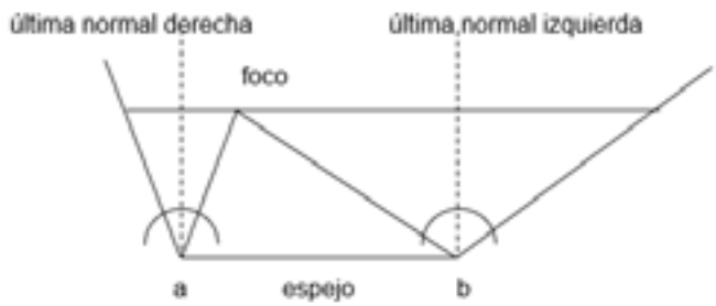
Figura 2.9.- Con el foco descentrado. Diferencia angular entre ambos márgenes.
