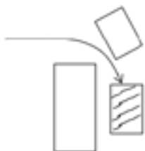
Figura 1.22.- Inclinación de bloque con efectos contraproducentes hacia la superficie del estanque.
