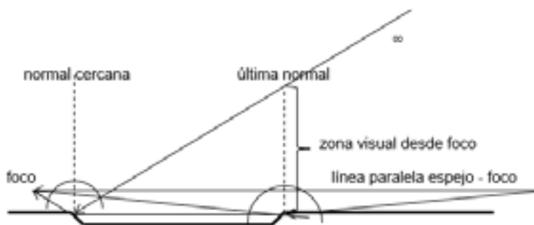
Figura 2.24.- Capacidad máxima de reflexión del estanque, desde ese foco.
